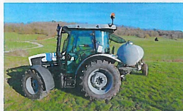
Son faible poids sur la bascule et sa bonne garde au sol, de 39 cm, lui permettent d'entrer dans les parcelles humides.
