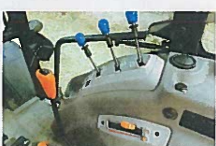
Les trois leviers de commande hydraulique disposés sur la console de droite tombent sous la main.
