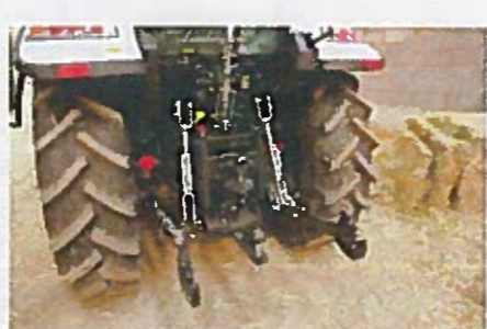
Le relevage arrière, d'une capacité de 3500 kg, bénéficie d'une commande externe mécanique identifiée en jaune.
