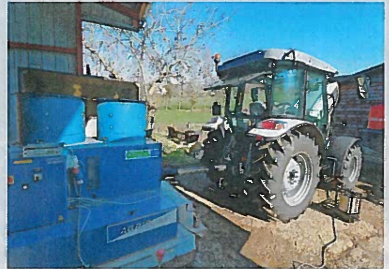
Devant le banc de la Cuma régionale de Bourgogne-Franche-Comté, le Lamborghini Spire 90 Trend a développé une puissance maximale de 73,6 ch OCDE à 1800 tr.min -1 .
