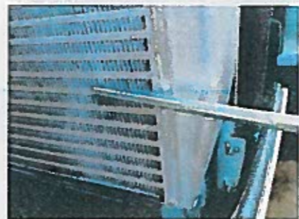
Un tuyau perforé avec un embout normalisé pour le compresseur d'air intégré sous le capot facilite le nettoyage des radiateurs.
