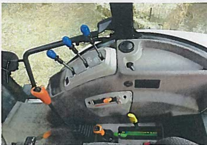
Les commandes mécaniques sont bien agencées et regroupées selon un code couleur.
